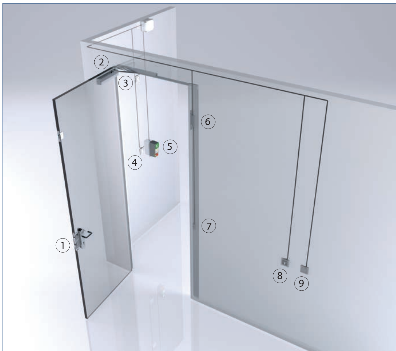
1 = Panikschloss mit Wechselfunktion „E“ bauseits | 2 = Türschließer TS 4000/TS 5000 | 3 = Taster auf 1,80 m Höhe | 4 = Schalter zum Aktivieren bzw. Deaktivieren des äußeren Tasters | 5 = Türzentrale TZ 320 SN, AP/UP | 6 = Fluchttürverriegelung FTV 320 | 7 = Elektrischer Türöffner A5000--B | 8 = Schlüsseltaster | 9 = Taster außen
