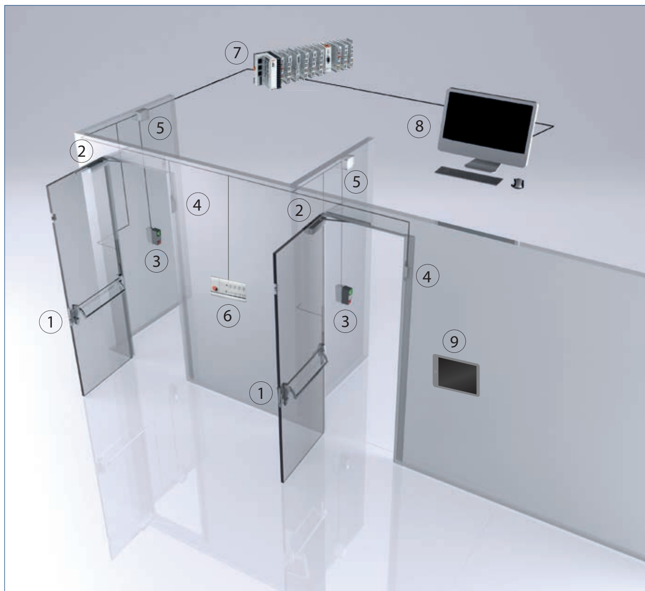
1 = Motorschloss IQ lock EL | 2 = Türschließer TS 4000 / TS 5000 | 3 = Türzentrale TZ 320 | 4 = Fluchttürverriegelung FTV 320 | 5 = Motorschlosssteuerung MST 210 | 6 = Tableaeinheit TE 220 | 7 = myGEZE Control | 8 = Visualisierung / Gebäudeleittechnik | 9 = Visualisierung / Gebäudeleittechnik auf Touchscreen (optional)
