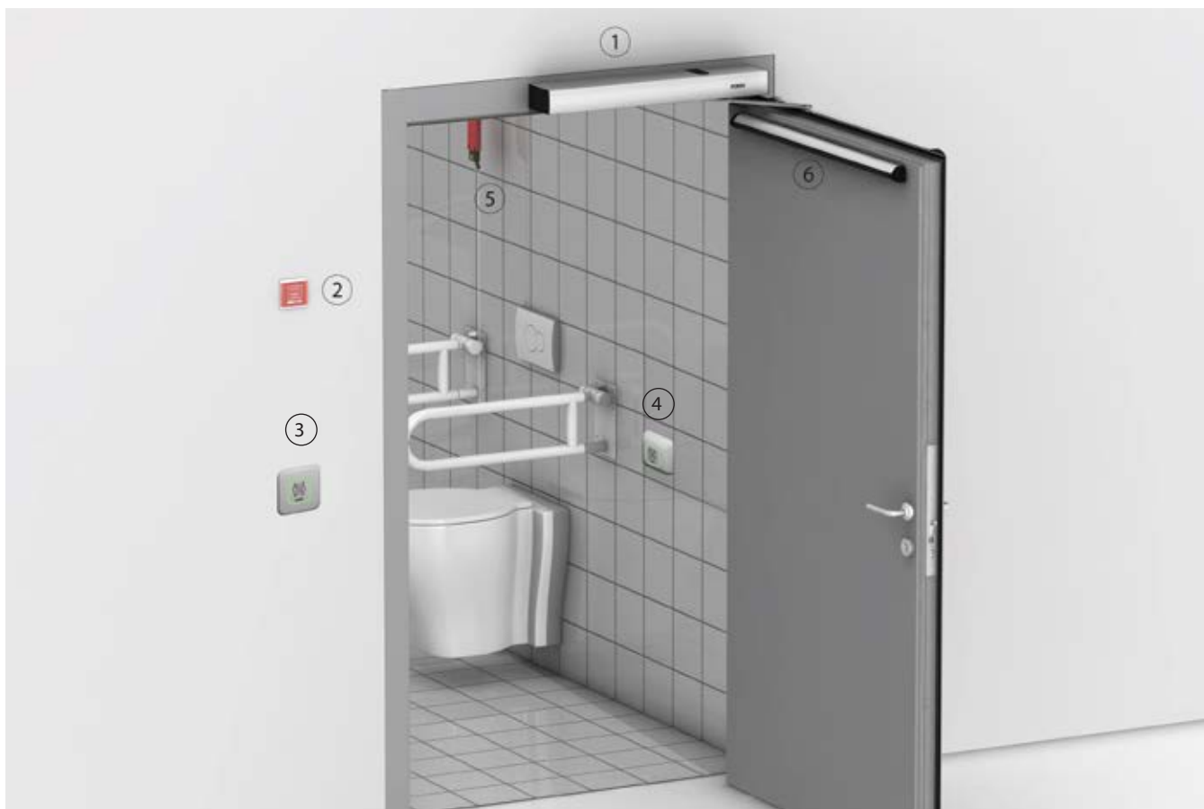
1 = Drehtürantrieb | 2 = Not-Auf-Schalter (Empfehlung Installationshöhe: 1600 mm) | 3 = Berührungsloser Näherungstaster (UP) | 4 = Berührungsloser Näherungstaster (AP) | 5 = Zugschalter Notruf | 6 = Sensorleiste
